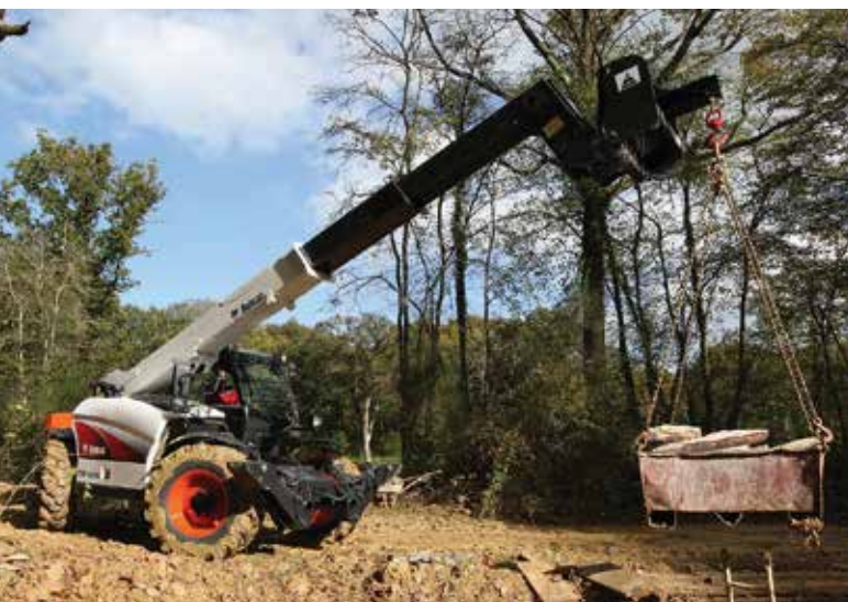
Der neue Bobcat Telehandler mit T36120SL mit Kranausleger.
