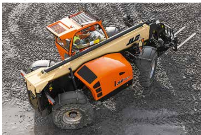
JLG stellt auf der Bauma zahlreiche Hubarbeitsbühnen und Teleskoplader vor. Unter anderen den Teleskoplader 4017RS mit einer Hubhöhe von über 17 m.
