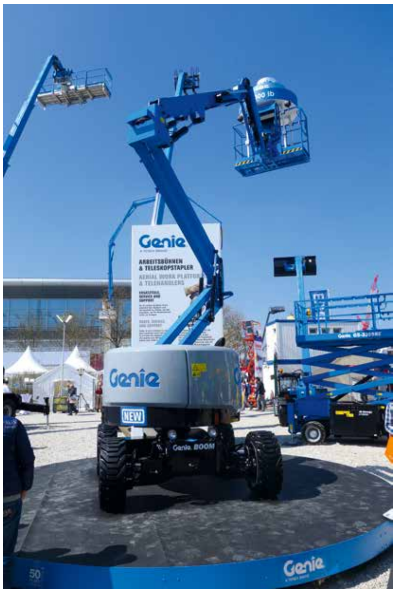
Die auf der Bauma gezeigte Genie Gelenkteleskop-Arbeitsbühne Z-45/25XC bietet bei etwas mehr Gesamtgewicht bis zu 100 % mehr Tragfähigkeit. BM-Bild
