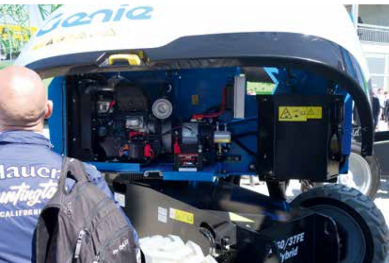
Durch die Anbringung der Batteriepakete im hinteren Teil konnte Kontergewicht eingespart werden. BM-Bild
