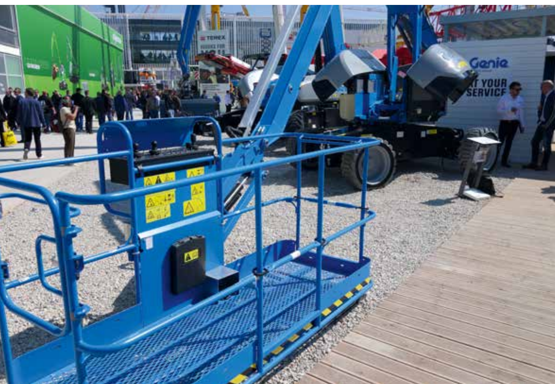
Der Einstieg in den Korb kann bei der neuen Arbeitsbühne an drei Seiten erfolgen: rechts, links und mittig.
