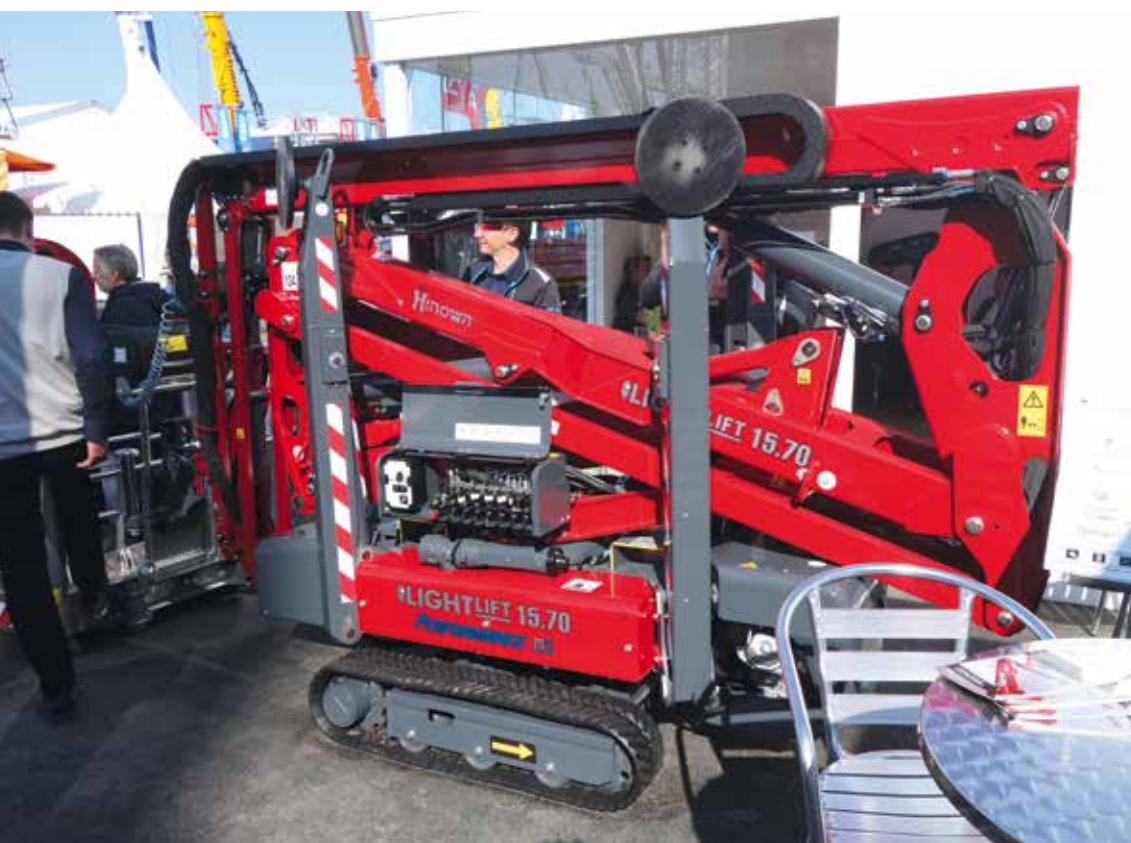
... die neue Raupen-Arbeitsbühne Lightlift 15.70 Performance IIIS.
