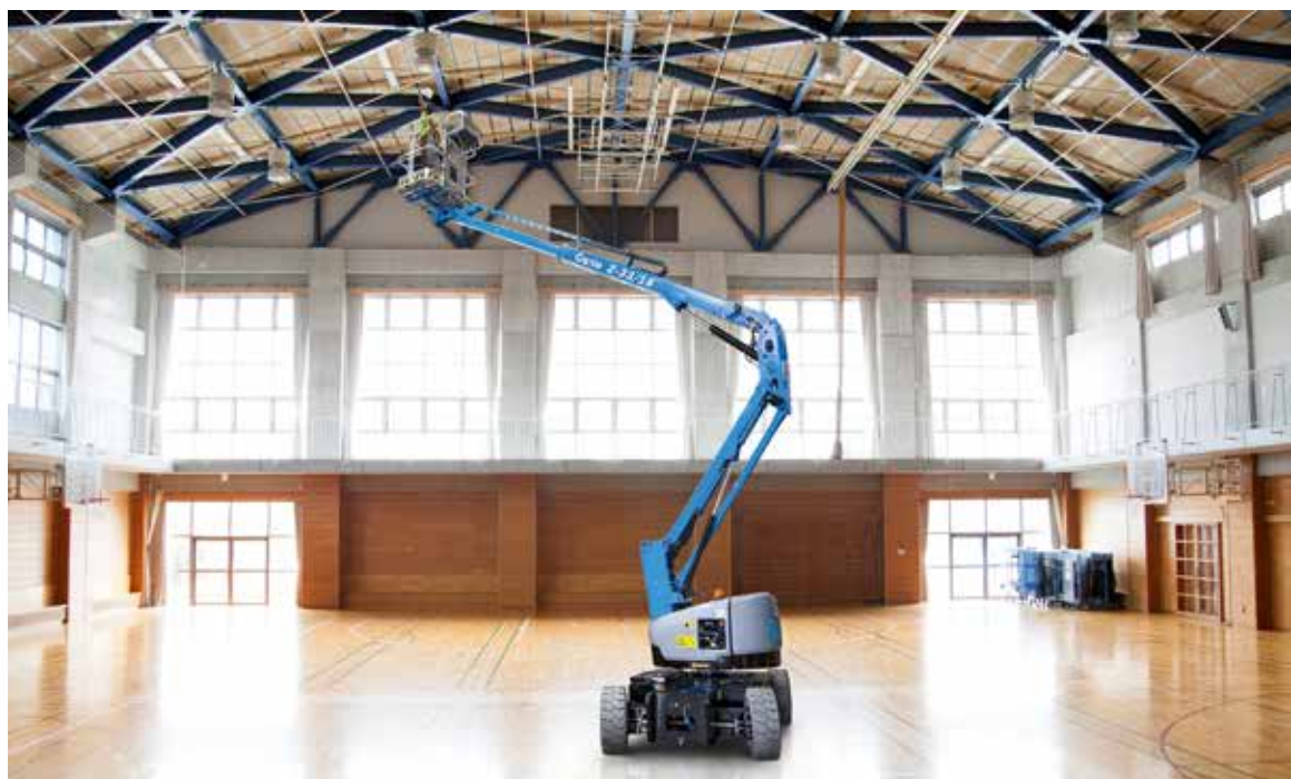
Wird laut Genie als „Schweizer Taschenmesser der Zugangstechnik“ bezeichnet: die Gelenkteleskop-Arbeitsbühne Z-33/18.
