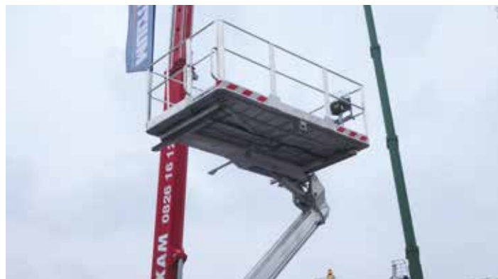
Die große Arbeitsplattform bietet nicht nur 400 kg Tragkraft, sondern ist auch seitlich verschiebbar.
