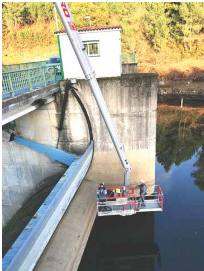
Unter Flur top: der T 570 HF. Da sich der Arbeitskorb um 440 Grad drehen lässt, können bei nach unten gerichtetem Korbarm Brückenuntersichteinsätze effizient und sicher ausgeführt werden.
