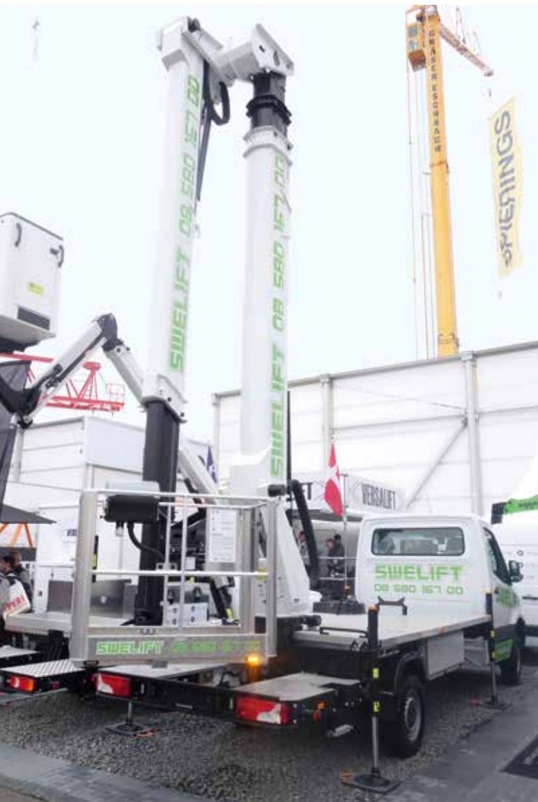
Verwendet auch ein Mercedes-Benz Sprinter-Chassis: der VTX-240. Dank des Bühnenaufbaus mit zwei Teleskopausleger, die mittels Gelenk verbunden sind, kann senkrecht an Objekten hochgefahren werden und dann horizontal über diese hinweg gearbeitet werden.
