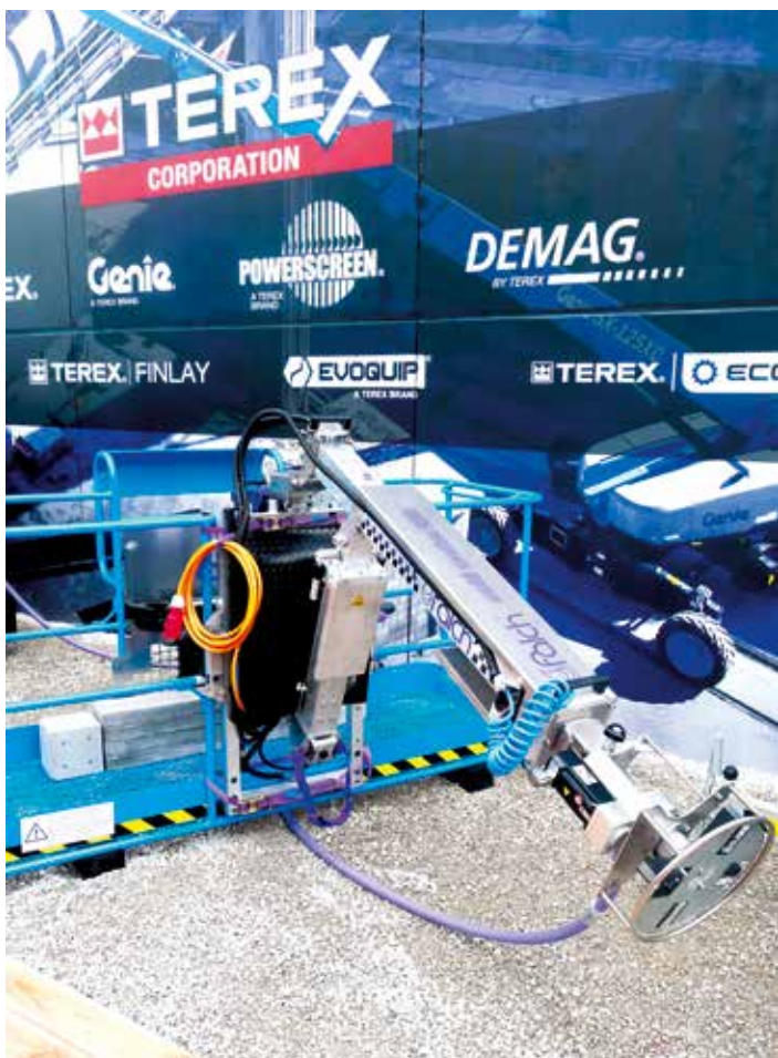
Auf dem Genie-Stand war auch die Falch GmbH mit einem Hochdruckwasserstrahlgerät vor Ort, welches mit Genehmigung durch Terex AWP an der Genie Teleskoparbeitsbühne SX-135XC installiert und verwendet werden kann. BM-Bild
