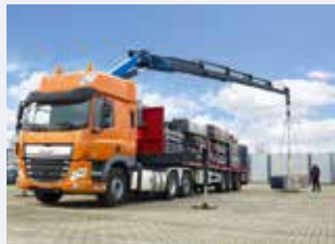
Der CF FTN 440 mit gelenkter Nachlaufachse inklusive Ladekran.
