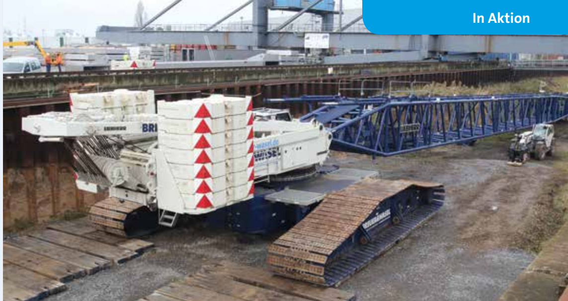
Wie geduckt: einer der beiden Liebherr LR 1600/2 im Vorfluterbecken. Die Kranportalbahn im Hintergrund muss über den Raupenkran hinweg verfahren werden.
