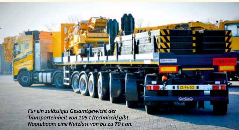
Für ein zulässiges Gesamtgewicht der Transporteinheit von 105 t (technisch) gibt Nootboom eine Nutzlast von bis zu 70 t an.
