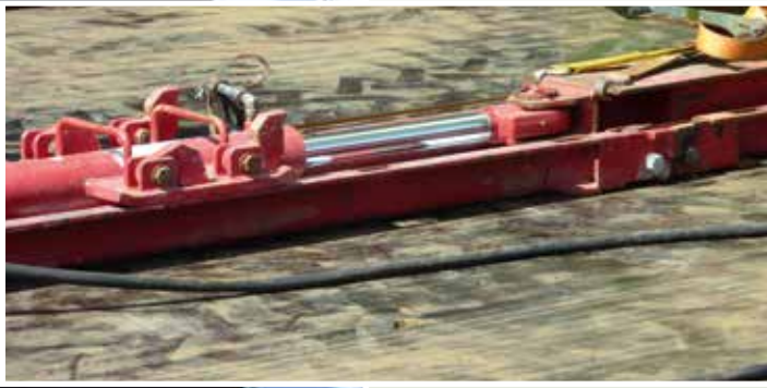
Auf Verschubbahnen wird das Traggestell aus der Materialschleuse heraus verschoben. KM-Bilder
