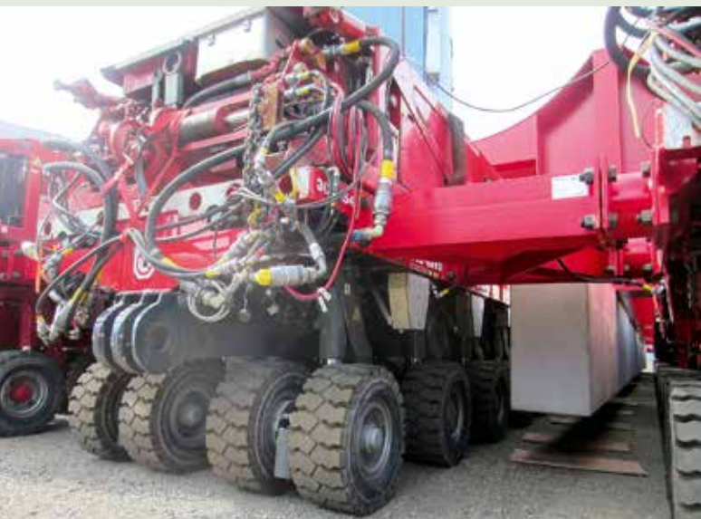
Das Transportgestell wird zur Materialschleuse transportiert. Dies ist zugleich auch eine Testfahrt.
