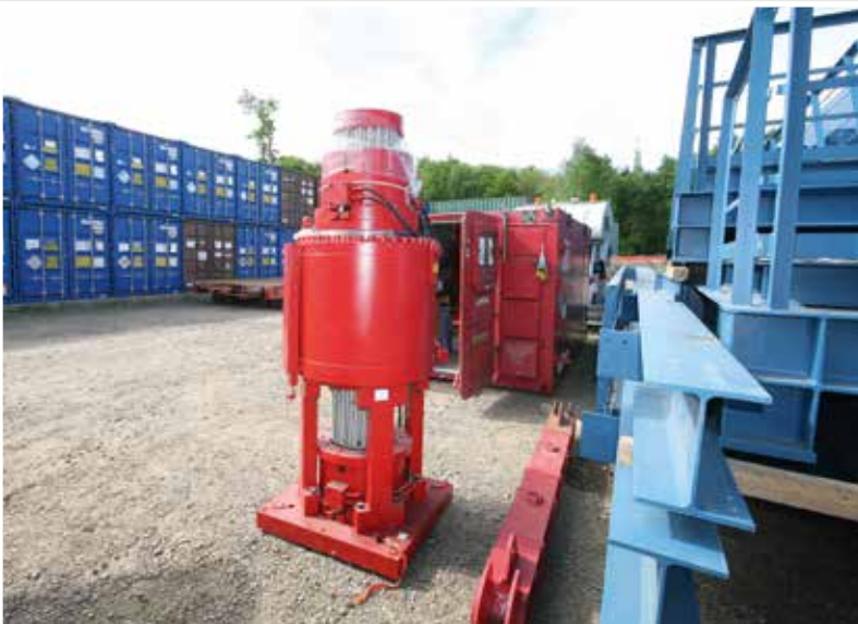
Zusätzliche Sicherheit: Ein gewaltiger Litzenheber, fabrikneu, mit 900 t Tragkraft steht hier bereit, falls ein im Einsatz befindlicher Litzenheber ausfallen sollte. KM-Bild
