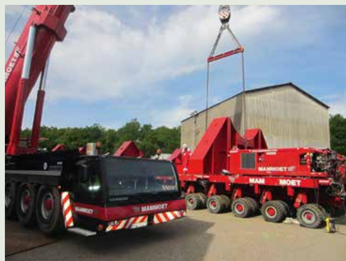
Das Transport- und Lagergestell wird montiert.
