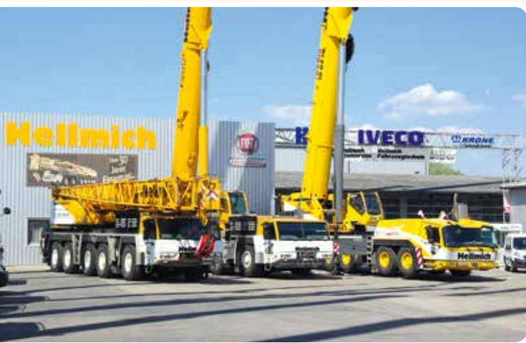
2x ATF 220G-5 und GMK 6300L mit 80 m Tele + 37 m hydraulischer Wippe.
