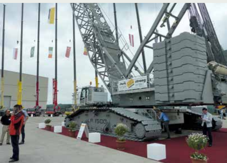
Der neue Liebherr-Raupenkran LR 1500 bietet Traglasten eines 500-Tonnners bei Abmessungen und Gewichten eines 400-Tonnners.
