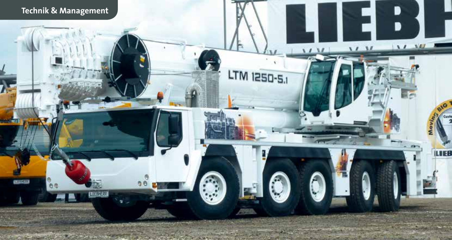
Mit dem LTM 1250-5.1 stellte Liebherr im Juni seinen zweiten 5-Achser in Euromot 4 7 Tier 4f-Ausführung vor.
