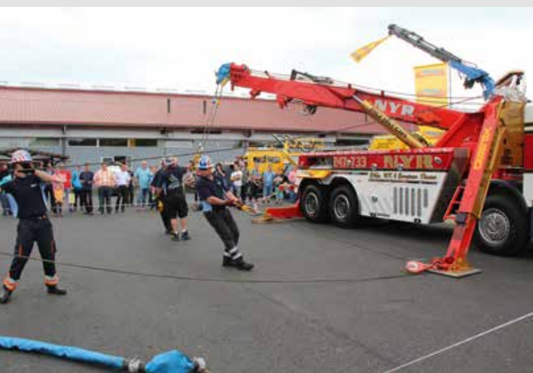
Vorbereitung des Rotator von Miller Industries Europe auf die Praxisvorführung, bei der ein Lkw-Anhänger aufgestellt wurde.
