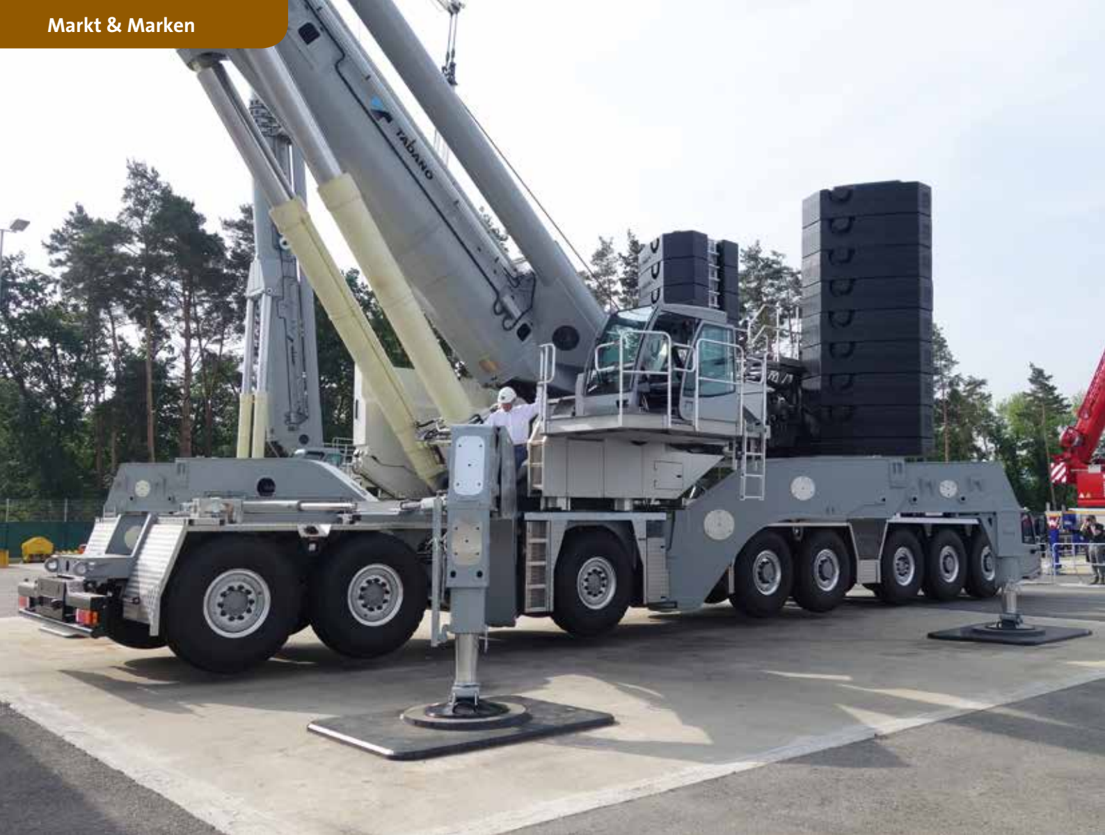
Beim ATF 600G-8 war ein konstruktives Ziel, den Hauptausleger so stark zu machen, dass der Kran ganz ohne Hauptauslegerabspannung auskommt.
