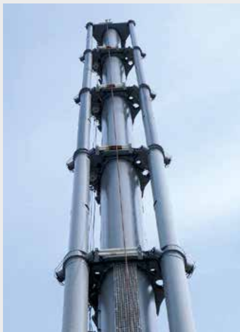
Der Triple-Boom des ATF 600G-8.
