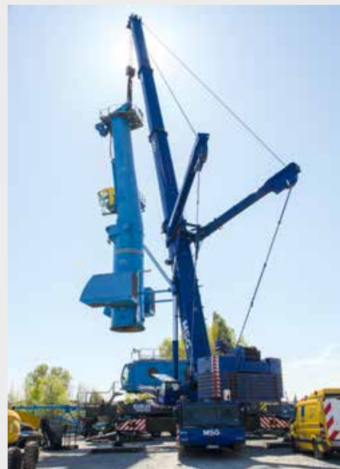
LTM 1500-8.1 im Einsatz mit Y-Abspannung. Bild: HSMS
