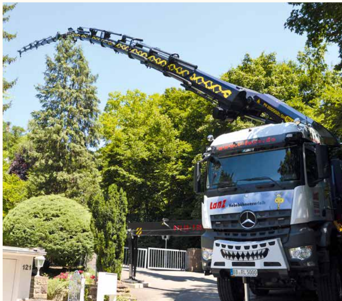
Der Ausleger mit wartungsarmen Achtfach-Ausschub bietet 46 m maximale Reichweite.
