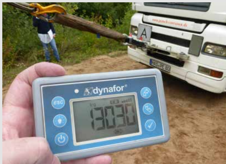
Es wurde praktisch herausgestellt, welche Kräfte beim Herausziehen eines Havaristen benötigt werden.
