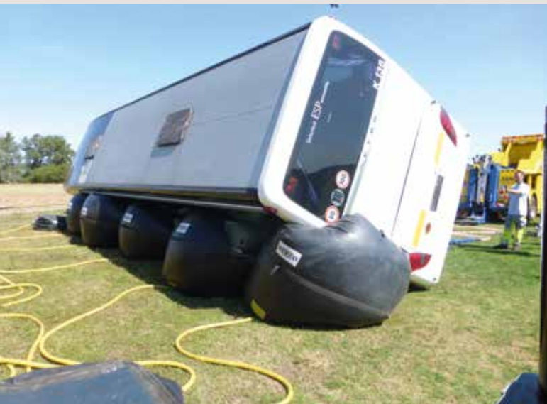
Der Bus wurde nach dem Überschreiten des Kippunktes von den Catchbags sanft abgefangen.
