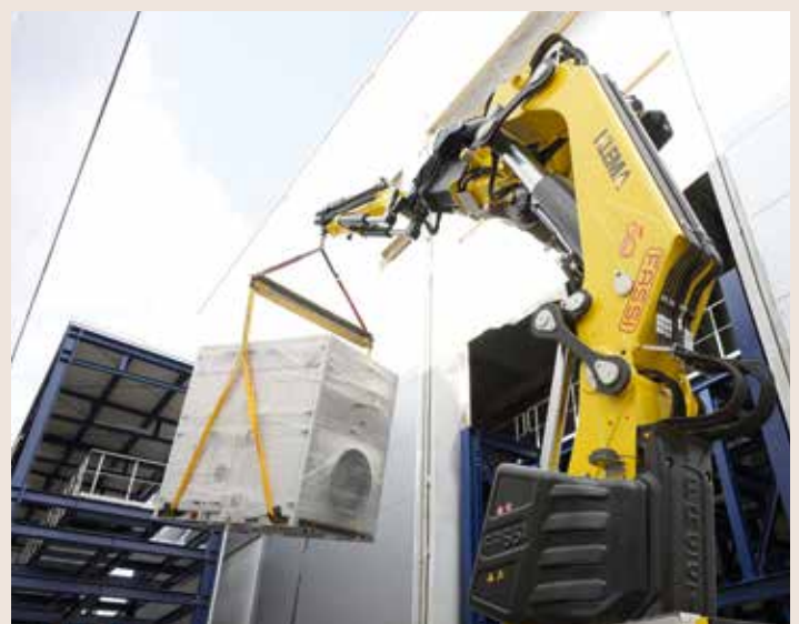
Der Fassi F 1300 kann schwere Lasten auf engstem Raum bewegen und positionieren.
