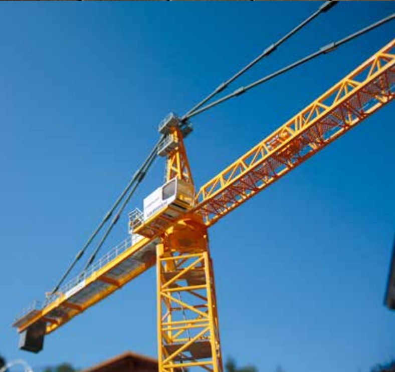
Der Ausleger erhielt eine doppelte Abspannung.
