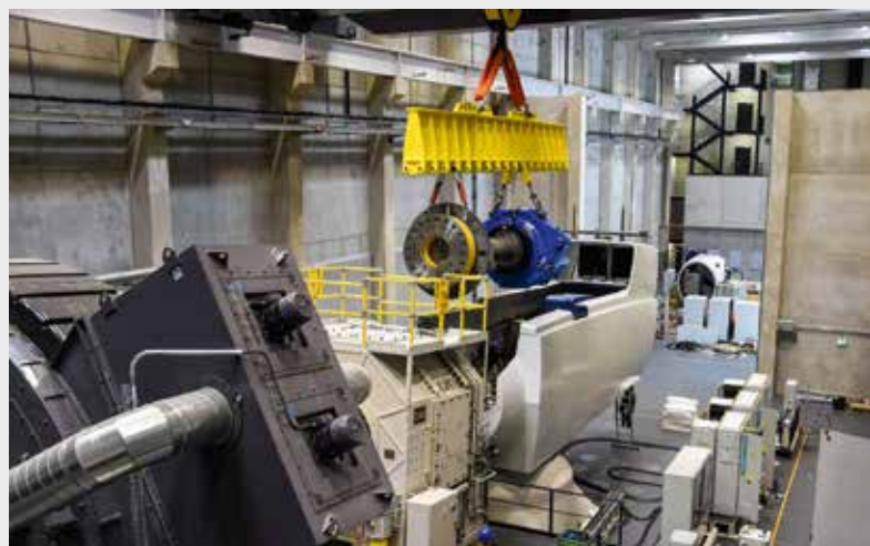
Hier gehört frischer Wind zum Arbeitsalltag: Am Center for Wind Power Drives (CWD) der Universität Aachen prüft ein Forscherteam Windkraftanlagen und entwickelt effizientere Antriebsstränge. Die Bauteile sind enorm schwer und die Windkraftexperten benötigen deshalb eine leistungsfähige Transportlösung. Konecranes konzipiert für das CWD einen maßgeschneiderten Smarton mit sehr hoher Tragkraft und besonderen Smart Features – die beim Transport eigenständig für mehr Sicherheit sorgen.
