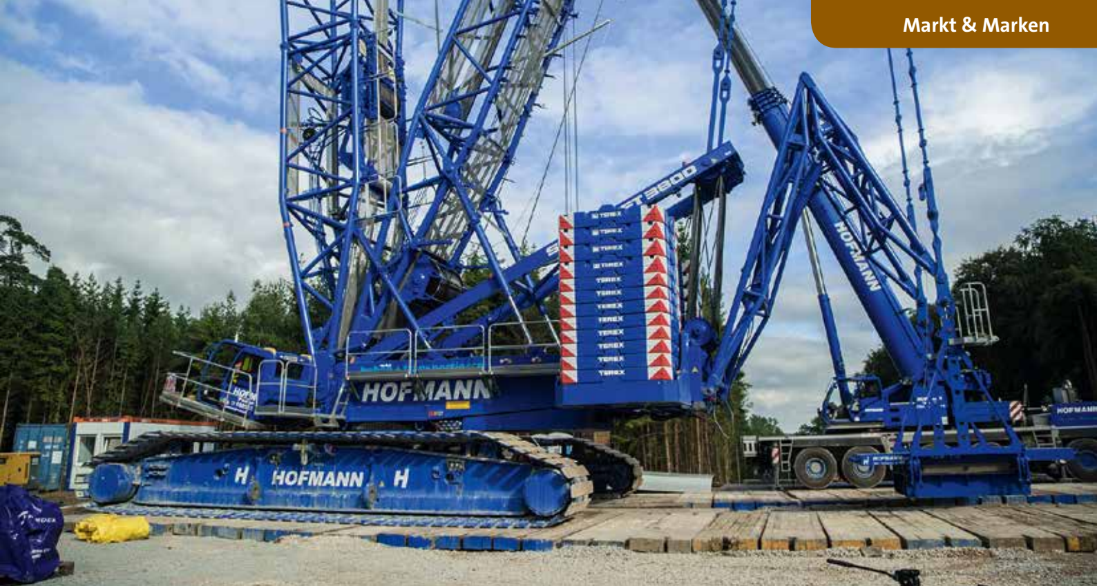
Beim Aufbau einer Nordex Windkraftanlage für den Auftraggeber „KS Regenerative Energie“ bei Bickenbach im Hunsrück setzte der Krandienstleister Hofmann Kran-Vermietung GmbH & Co. KG aus Paderborn auf den Gittermast-Raupenkran Demag CC 3800. Um die erforderliche Nabhöhe von 164 m zu erreichen, rüstete das Hofmann-Team den Kran mit vollem Boom Booster inklusive Flex Frame und Split Tray.
