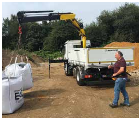
Der HC131K von Hyva wurde speziell für die Anforderungen der Bauwirtschaft in Verbindung mit Kipp-Aufbauten optimiert.
