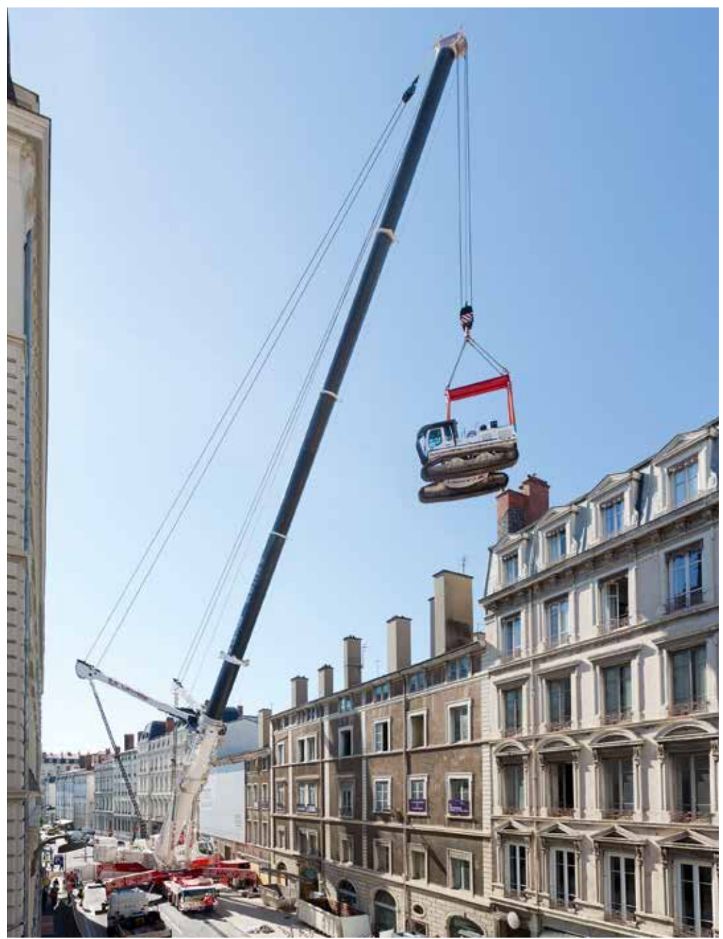
Liebherr am Haken von Liebherr: Der LTM 11200-9.1 hebt Liebherr-Bagger und Ausrüstungen über die Dächer von Lyon.
