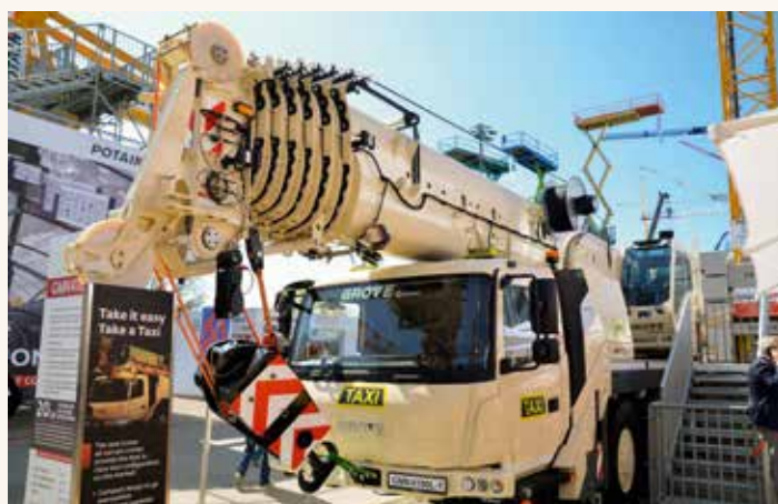
Mit modernem Lenksystem und Faserseil: der GMK4100L-1 auf der bauma 2016.
