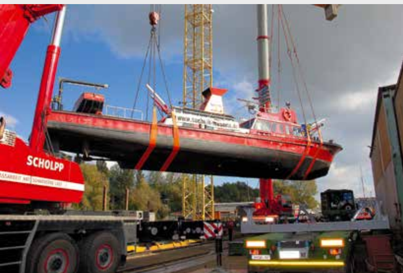
Der S-GK 220 und der S-HK 180 von Scholpp heben das Boot im Tandem.
