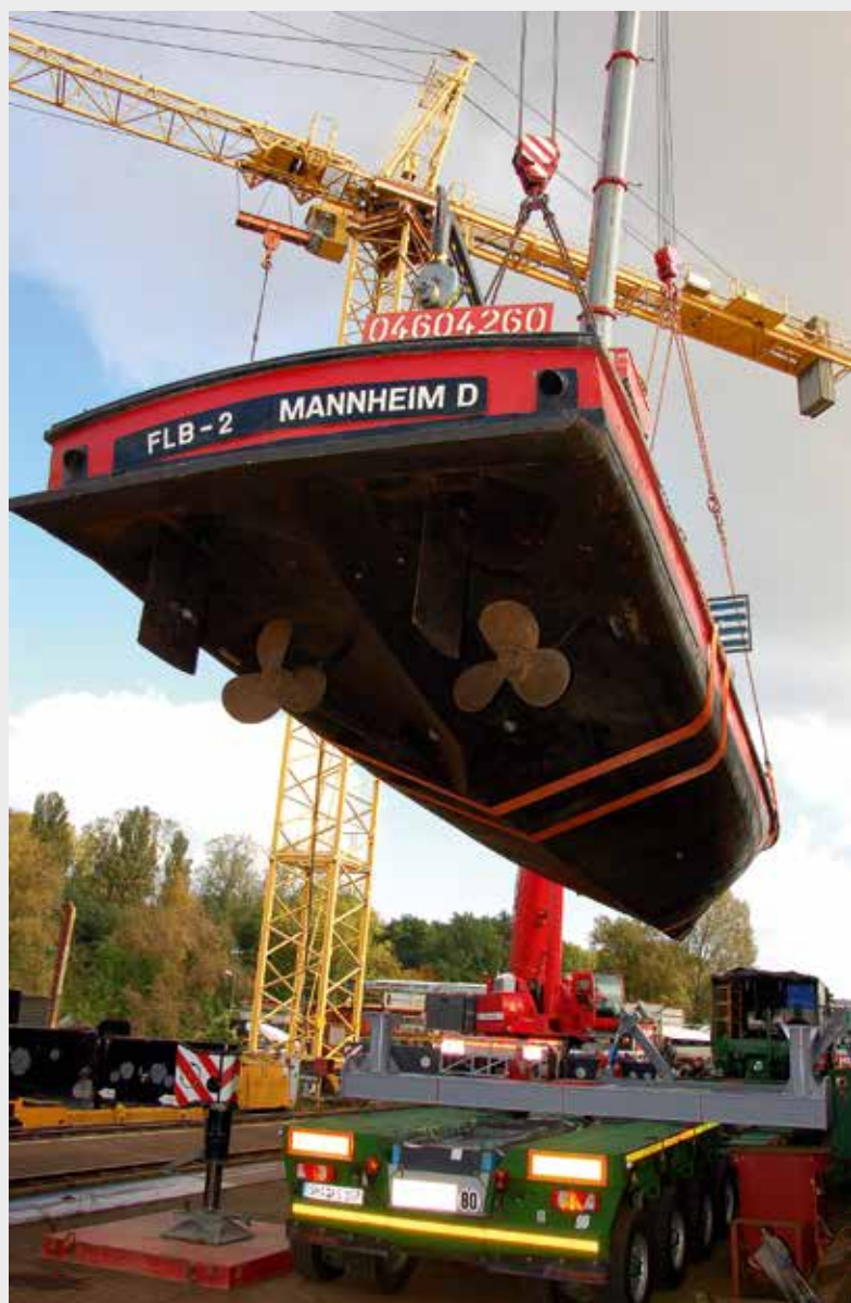
Mit Rundsclingen gesichert „schwebt“ das Feuerlöschboot auf den bereitstehenden Trailer.
