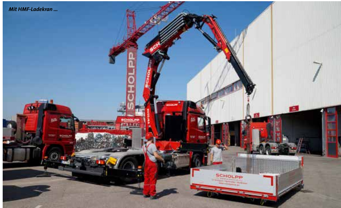
... lässt sich die Transportpritsche demontieren.
