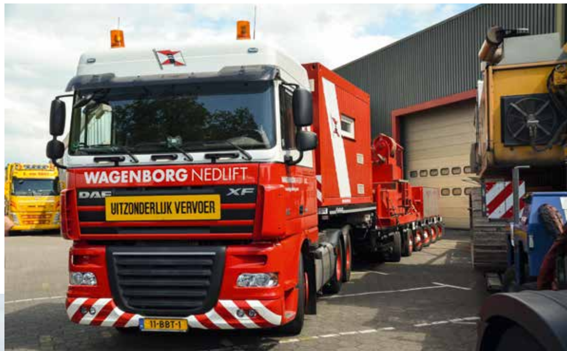
Zusehends setzen Kranbetreiber auf Semitiefloader zum Transport von Kranzubehör. Bilder: Hermann Schulte
