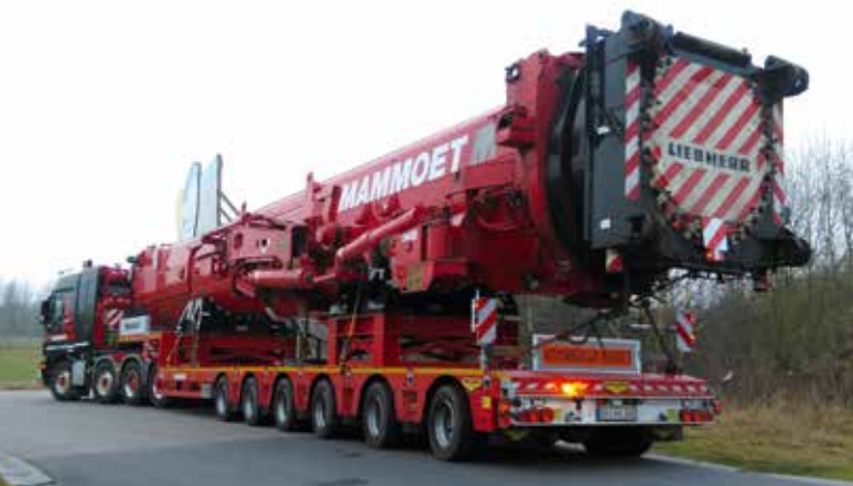
Für den Transport des Grundauslegers der Liebherr-Krans LTM 11200-9.1 investierte Mammoet in 6-achsige SL-Trailer.
