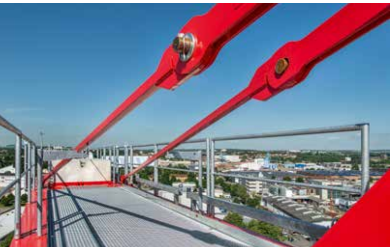
Der Gegenausleger mit Montagestützen für die Auflage der Abspannstangen und die Transporthilfe für die Auslegerstücke.
