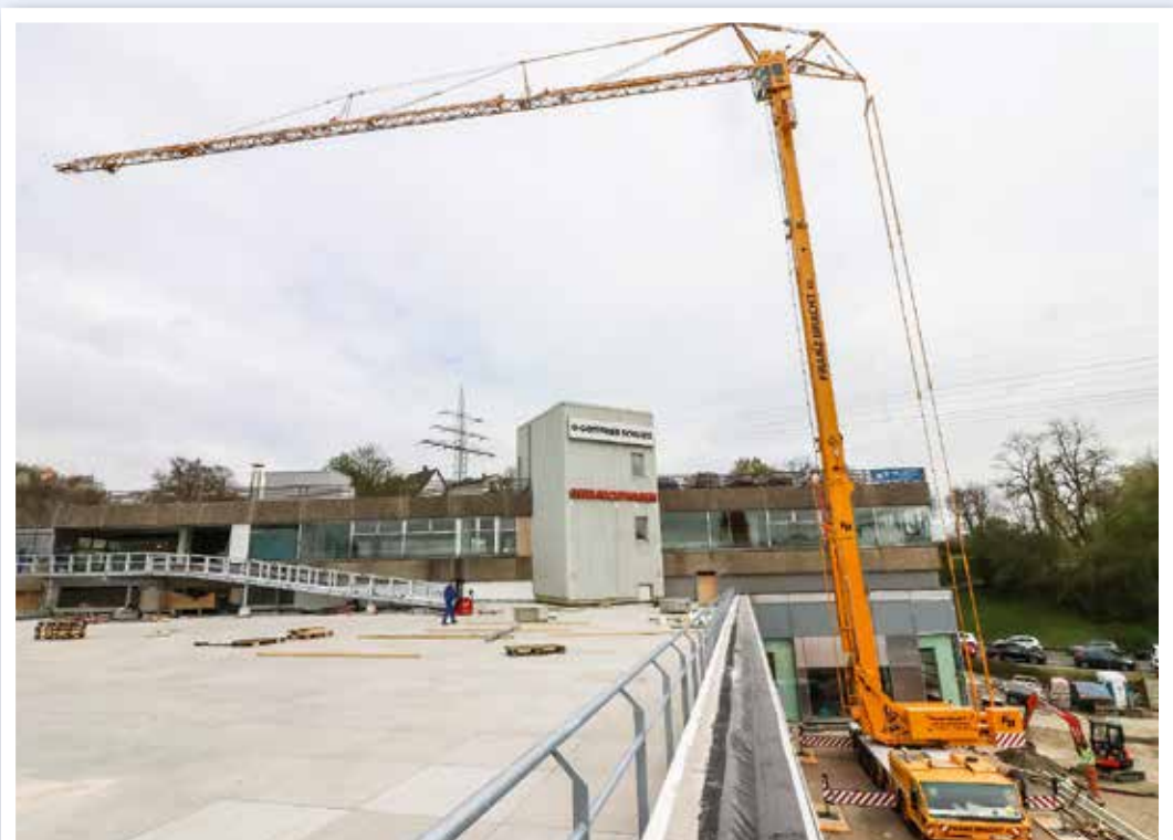
Der Spierings SK1265-AT6 bietet 60 m Auslegerlänge und eine 1.700 kg Tragkraft an der Auslegerspitze. Bild: Michael Bergmann
