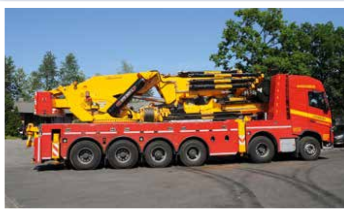
World Power-Kran ER-375.000-L auf 6-Achs-Volvo.
