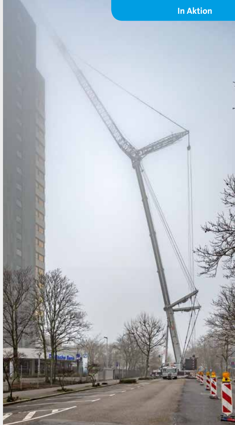
... sorgten dafür, dass die geforderte Traglast von 7 t auf 43 m Ausladung erreicht werden konnte.
