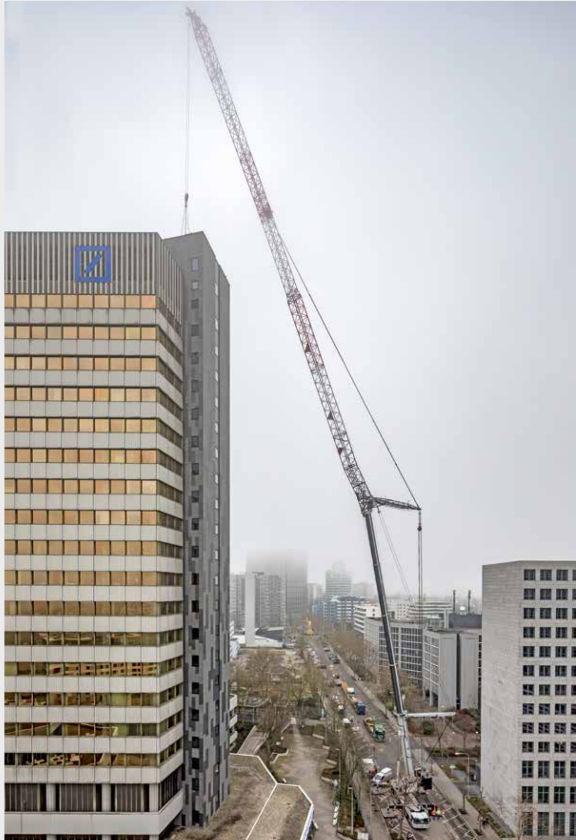
Der Grove GMK6400 war bei diesem Einsatz in Frankfurt 79 m langer Wippspitze gerüstet worden.
