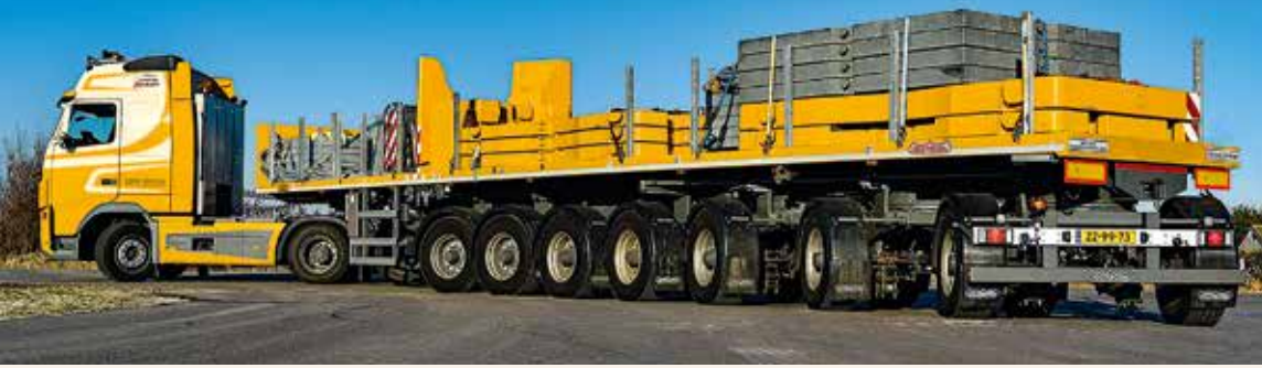
Einsatzbeispiel Ballasttrailer: Bei einer Ladehöhe von 1 m werden schon Maßnahmen zur Absturzicherung notwendig.
