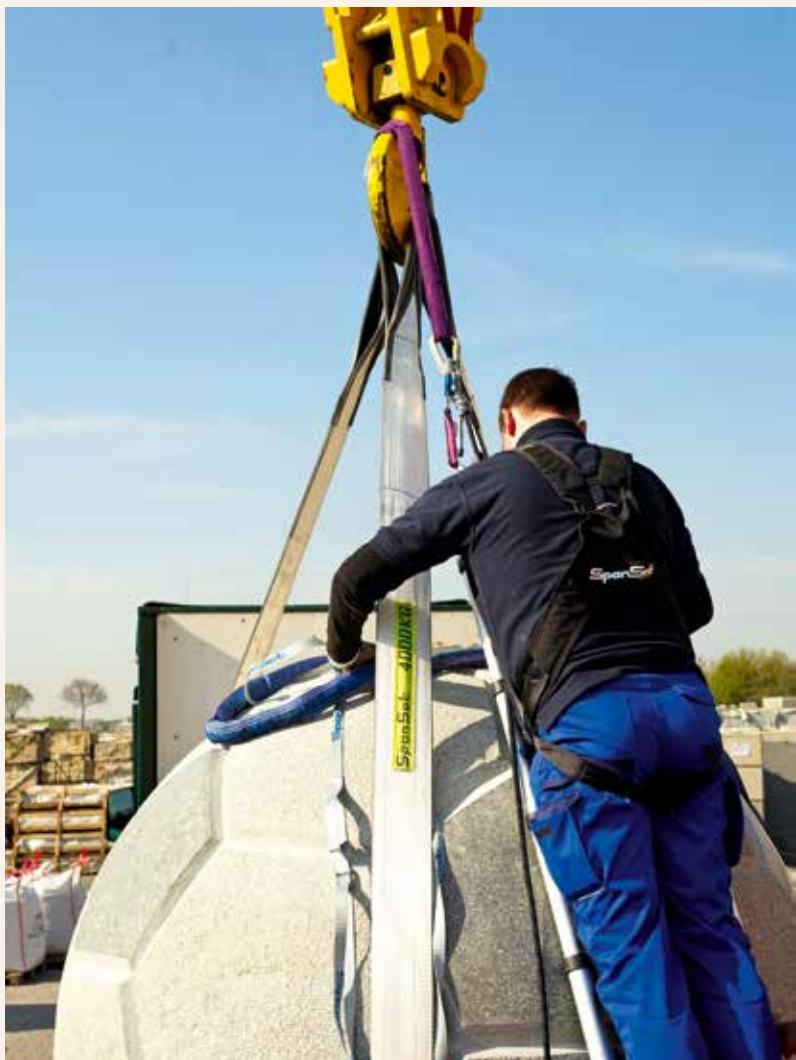
Beim Arbeiten auf Trailern empfiehlt sich eine Kranhakensicherung.
