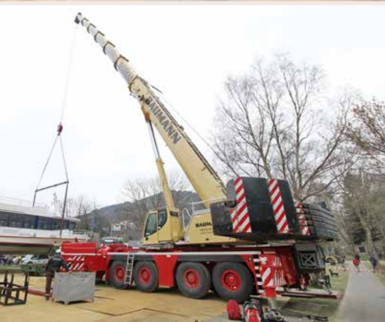
Der LTM 1300-6.2 verfügt über 300 t maximaler Tragkraft und einen 78 m langen Teleskopausleger.
