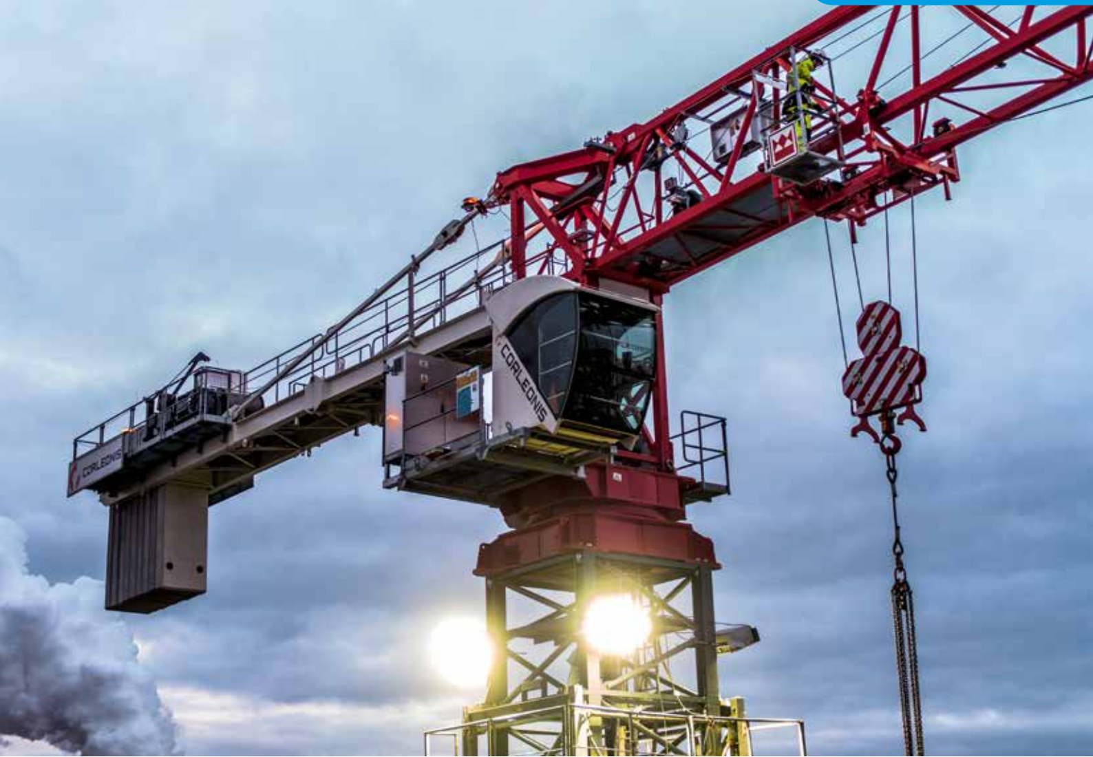
Bis zu 16 t Tragkraft bietet der CTT 332-16.
