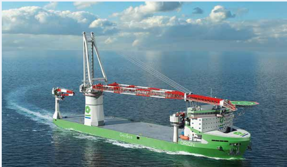
Zu den Leuchtturm-Projekten des vergangenen Jahres zählte die Produktentwicklung des Schwerlastkrans HLC 295000. Der Offshore-Kran wird einmal Windparks installieren und Offshore-Anlagen rückbauen. Mit einer Traglast von bis zu 5.000 t bei einer Ausladung von 35 m und einer maximalen Hubhöhe von mehr als 170 m wird er der größte jemals von Liebherr gebaute Kran sein.
