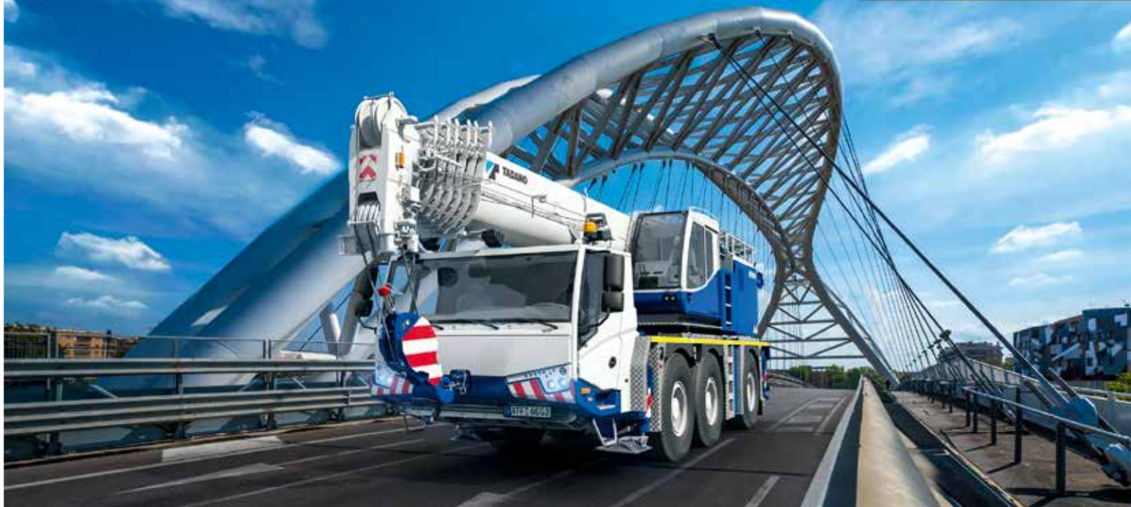
Auffällig beim ATF 60G-3 ist die Achsanordnung mit zwei Vorderachsen.
