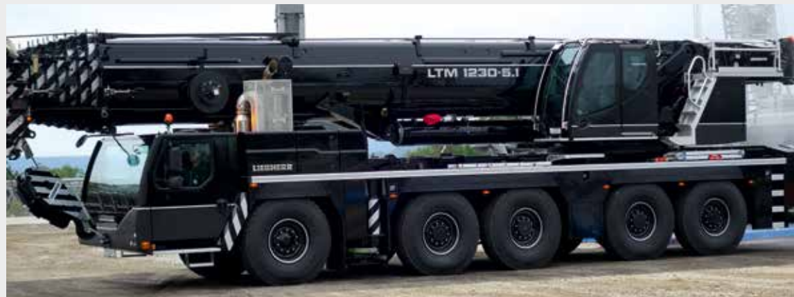
Mit dem 75 m langen Hauptausleger und 230 t maximaler Tragkraft bei gleichem Ballast übertrifft der LTM 1230-5.1 seinen Vorgänger, den LTM 1200-5.1 deutlich. KM-Bilder
