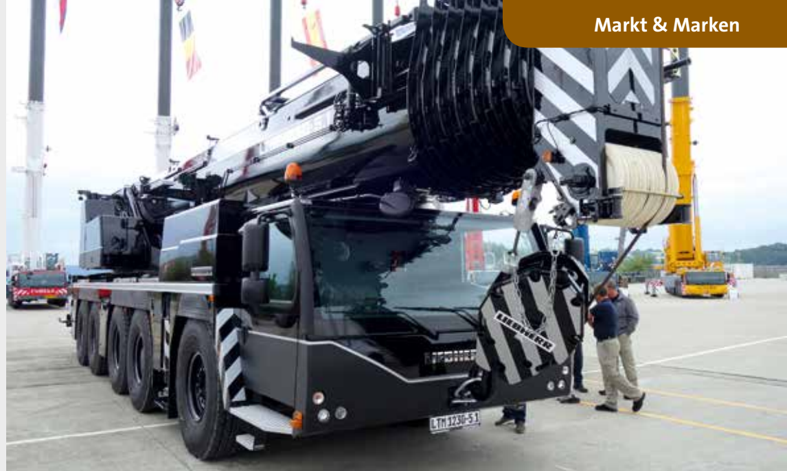
Mit dem 75 m langen Hauptausleger und 230 t maximaler Tragkraft bei gleichem Ballast übertrifft der LTM 1230-5.1 seinen Vorgänger, den LTM 1200-5.1 deutlich. KM-Bilder
