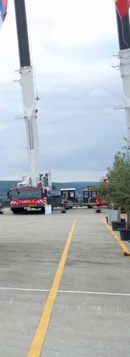
Mit dem 75 m langen Hauptausleger und 230 t maximaler Tragkraft bei gleichem Ballast übertrifft der LTM 1230-5.1 seinen Vorgänger, den LTM 1200-5.1 deutlich. KM-Bilder
