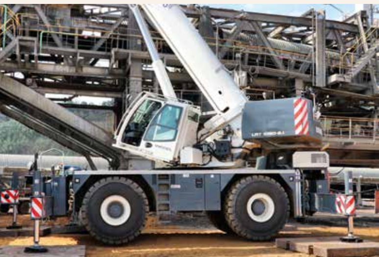
VarioBase sorgt für einen sicheren Stand und die nach hinten neigbare Kabine ermöglicht dem Fahrer eine bessere Sicht.
