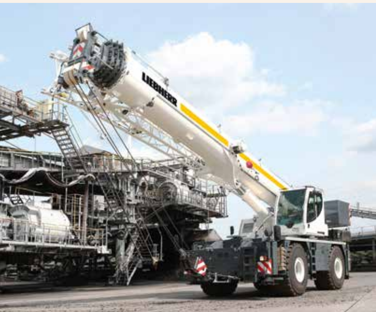
Da alle Komponenten fertig lackiert verbaut werden, gibt es den Kran nur in der Standardlackierung. Mit Folientechnik kann der Kran dann nach Kundenwunsch individualisiert werden, hier in der Liebherr-Version.
