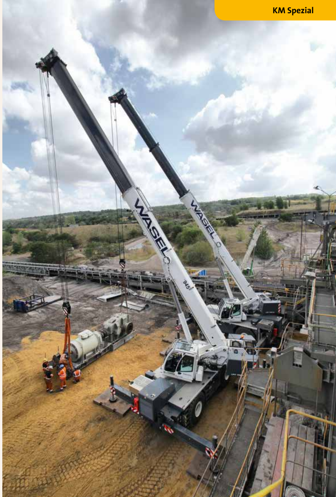
Der Tagebau Garzweiler ist für die Krane recht anspruchsvoll, aber dennoch das ideale Einsatzgebiet. Da oft mehrere kleinere Einsätze pro Tag anstehen, müssen die Krane flexibel und schnell aufgebaut sein. Auch die Geländegängigkeit wird im Abbau-Gebiet vorausgesetzt.
