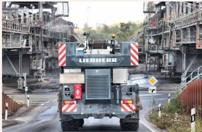
Im Tagebaugelände darf der Kran sich auch ohne Straßenzulassung auf den Straßen bewegen. Der RT-Kran ist 3,30 m breit.
