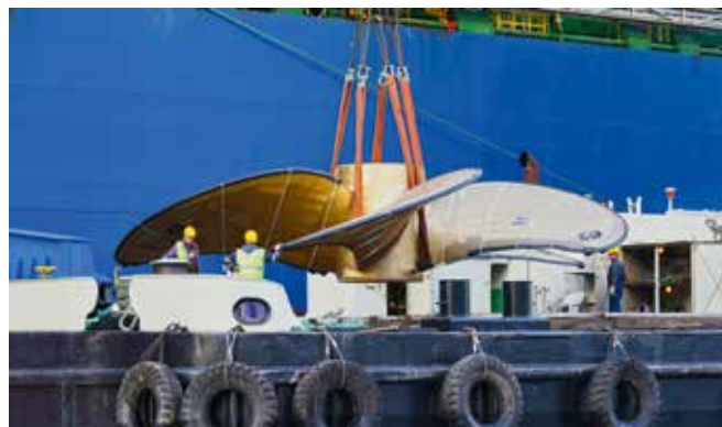
Der Schwimmkran „HHLA IV“ brachte den 110 t schweren Propeller in den Waltershofer Hafen und hob ihn dann in das Containerschiff „Hyundai Supreme“.
