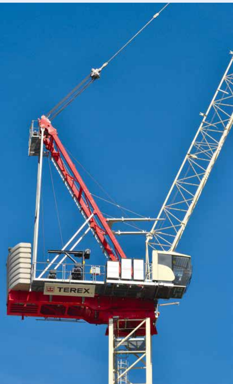
Die maximale Tragraft des CTL272-18 beträgt 18 t.
