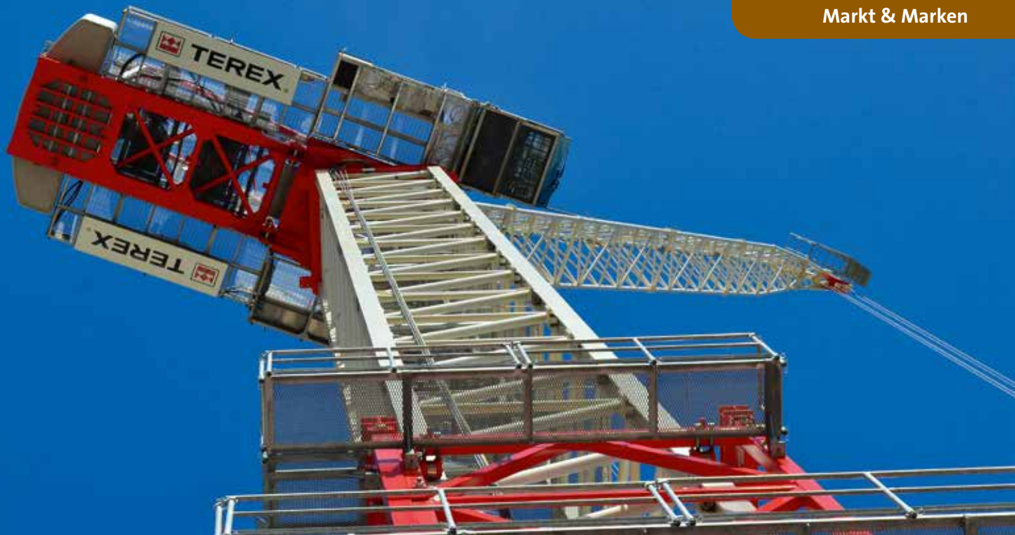
Bis zu 61 m Auslegerlänge bietet der neue Wipper von Terex.
