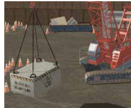
Das Trainingsmodul Für Raupenkrane simuliert einen 80 t-Raupenkran mit einer Auslegerlänge von 30 m. Auch hier zeigt der Bediener-Touchscreen Einsatzinformationen, die in Echtzeit aktualisiert werden, wie Ausladung, maximal zulässige Last, tatsächliche Last, Seilgeschwindigkeit und vieles mehr.
