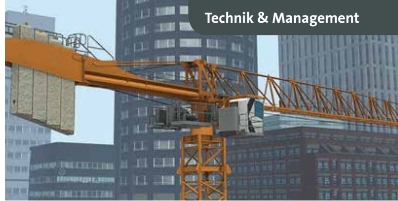
Mit dem Trainingsmodul für Turmdrehkrane lässt sich ein Kran mit maximal 12 t Traglast, bis zu 50 m langem Ausleger und 3,6 t Spitzentragslast simulieren. Turmhöhen sind von 43,7 bis 70,4 m möglich. Einsätze können im 2- oder 4-Strang-Betrieb gefahren werden.
