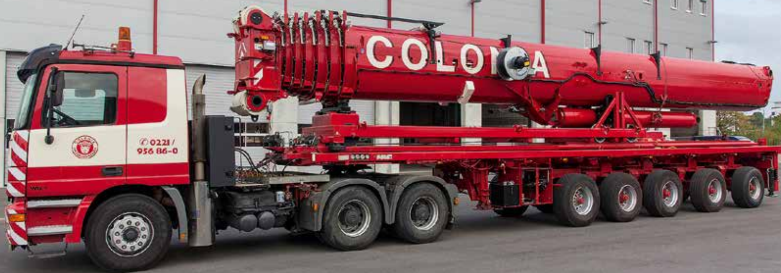
Um der Achslastproblematik zu begegnen, lässt sich der Teleskopausleger des GMK6300L-1 demontieren und separat zum Einsatz trailern.
