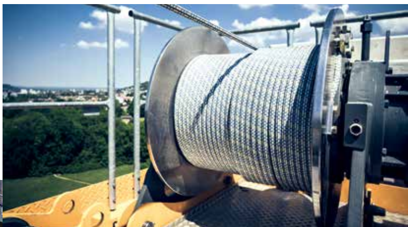
Die hochfesten Faserseile werden von Liebherr unterschiedlichsten Tests unterzogen – unter anderem auch auf Seilbiegemaschinen.
