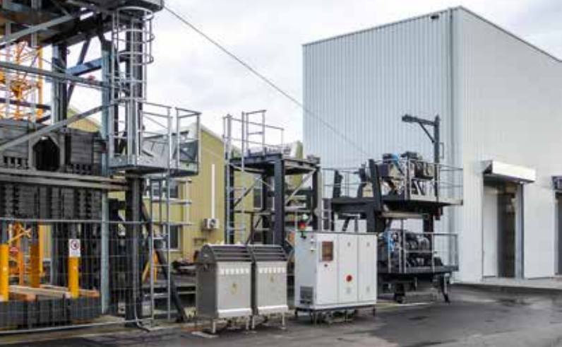
Die hochfesten Faserseile werden von Liebherr unterschiedlichsten Tests unterzogen – unter anderem auch auf Seilbiegemaschinen.
