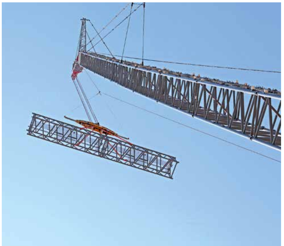
Die EMT sorgt für Stabilität in der Luft. Und das bei fast jedem Wetter, denn sie ist absolut windunempfindlich. Zwei große Scheinwerfer zum Ausleuchten des Arbeitsbereichs gibt es als Zusatzausrüstung, zudem zwei Kamerasysteme mit Bildanzeige auf der Funkfernsteuerung sowie optionale Lastmessbolzen zur Gewichtsanzeige auf der Funkfernsteuerung.
