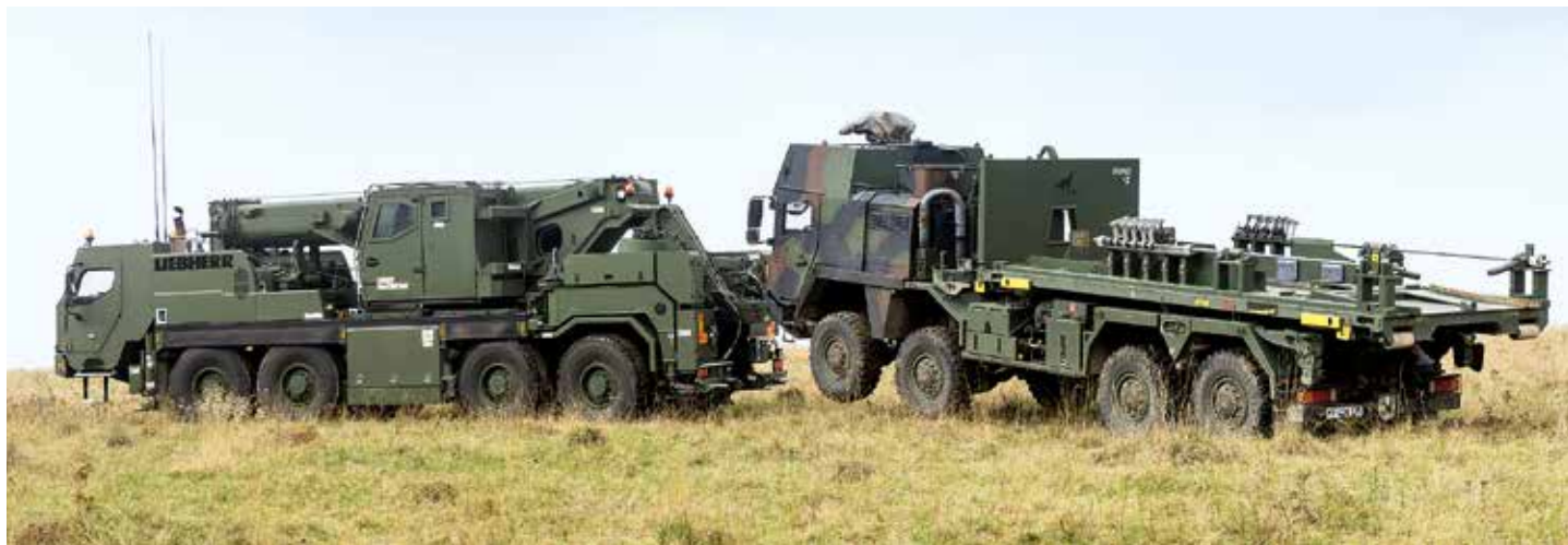
Das Liebherr Bergekranfahrzeug G-BKF eignet sich zum Bergen und Abschleppen einer Vielzahl von unterschiedlichen Fahrzeugen.
