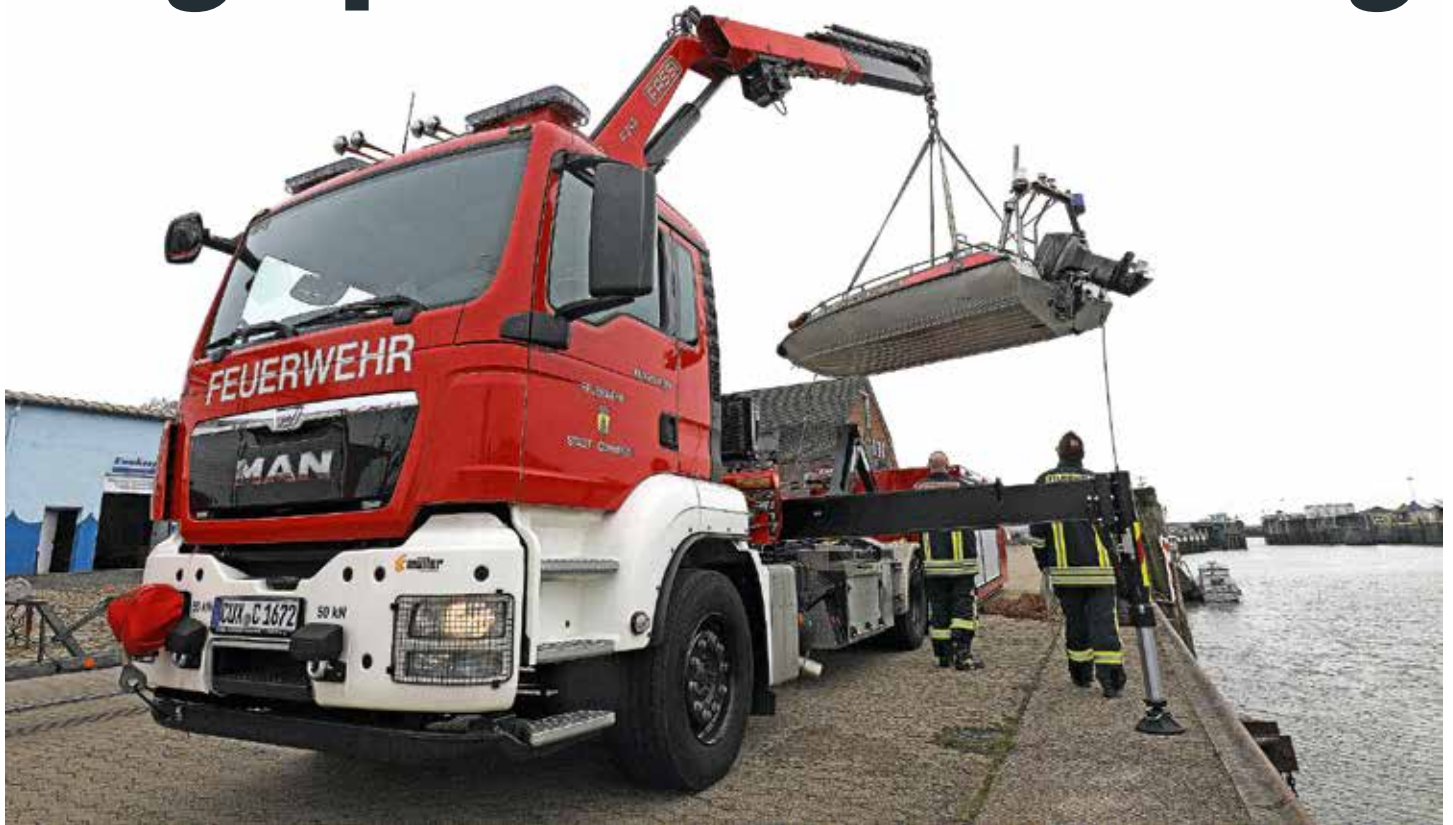
Am Haken des Fassi F245A.0.25 schwebt das Motorrettungsboot (RTB) der Cuxhavener Berufsfeuerwehr wieder zurück auf das Transportfahrzeug.
