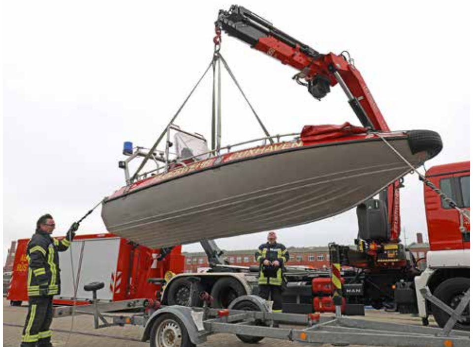
Erster Testlauf für die Wattrettung: Marco Otten vom Wattrettungszug (links) sichert mit seinem Kollegen Kai Schröder (nicht im Bild) das RTB der Feuerwehr, während Arne Katzenberger (Mitte) mit der RCS-Fernsteuerung den Fassi F245A.0.25 Richtung Hafenbecken dirigiert.
