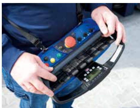
Mit der Fernbedienung lässt sich nicht nur der Ladekran, sondern auch der Lkw steuern.
