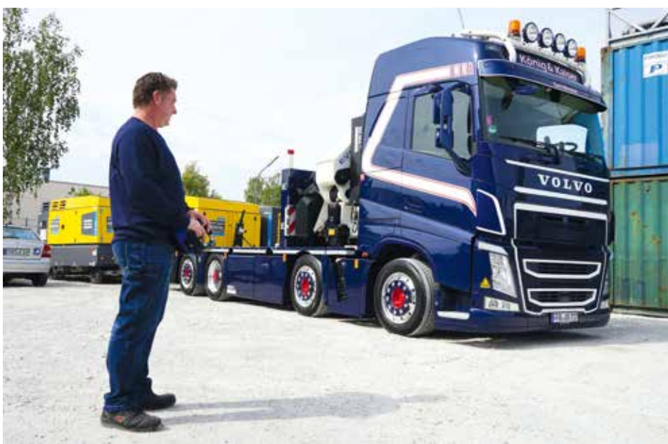
Mit der Fernbedienung lässt sich nicht nur der Ladekran, sondern auch der Lkw steuern.
