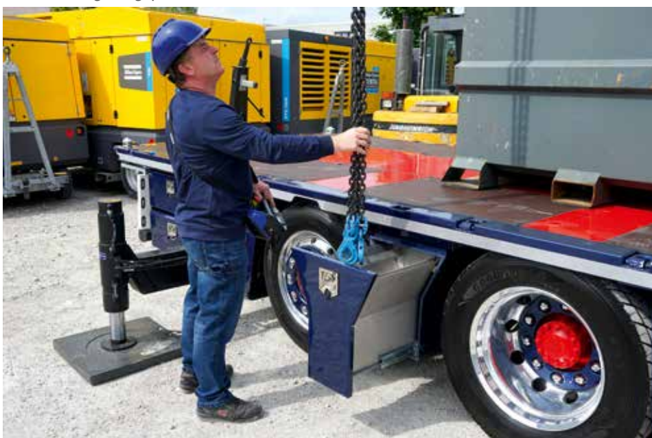
Saubere und sichere Lösung: Staufach für die Ketten. Auch die Abstützplatten können während der Fahrt sicher in eigenen Fächern verstaut und für den Einsatz bequem entnommen werden.
